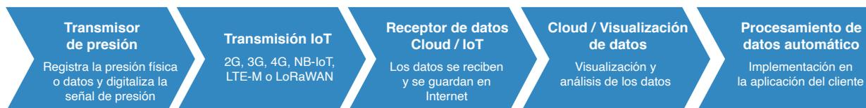
KELLER AG für Druckmesstechnik ofrece esta solución global esquematizada arriba consistente en un sistema de medición IoT basado en las tecnologías más recientes. Una solución de medición de estas características permite al usuario subirse al tren de la digitalización de forma inmediata, sin invertir mucho tiempo y a un bajo coste:
